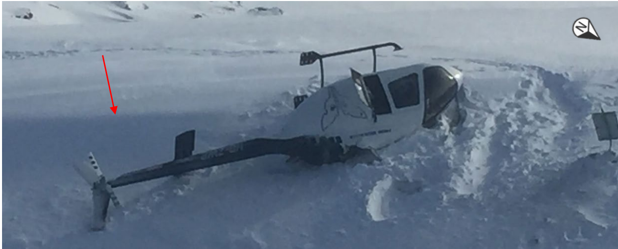
Abbildung 2: Endlage des Helikopters nach dem Unfall. Auf dem Bild ist durch den Schattenwurf die Schneeverwehung (siehe roter Pfeil) sichtbar.
