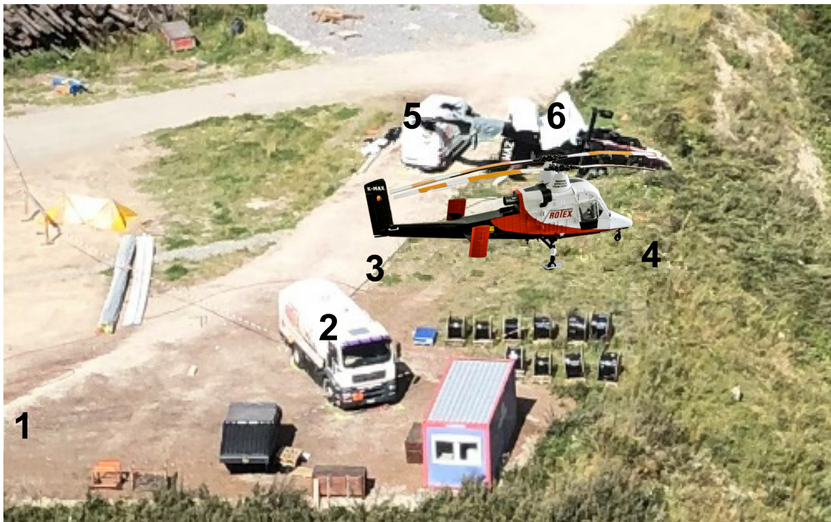
Figure 5: Organisation de la place d'avitaillement, avec le crochet électrique, extrémité de l'élingue de 55 m (1), la citerne JET-A1 (2), le tuyau d'avitaillement cheminant sous la poutre de queue de l'hélicoptère, le pistolet est préparé sur un support à gauche de la machine (3), le positionnement de l'hélicoptère au sol pour l'avitaillement en montage photo (4), camionnette « Sprinter » (5) et l'hélicoptère accidenté, couché sur le côté gauche (6).
