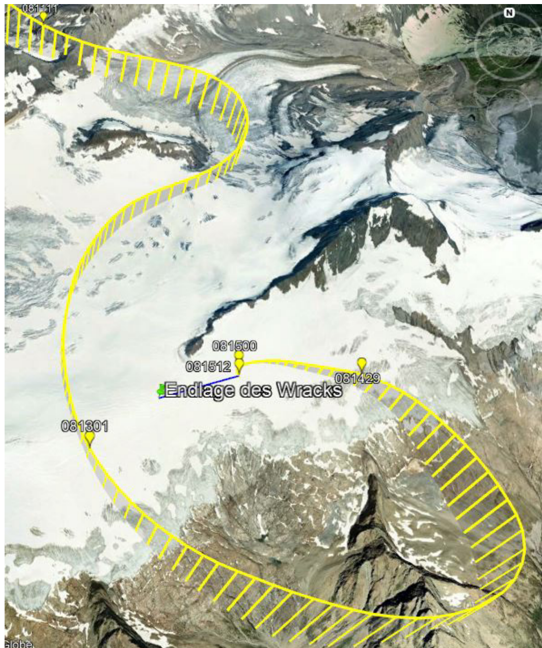
Abbildung 1: Gelb dargestellt der Flugweg der HB-ZTM, aufgezeichnet durch das digitale Kartendarstellungsgerät an Bord des Helikopters. Einzelne ausgewählte Zeitpunkte, die im Text erwähnt werden, sind speziell markiert, wobei die Zeiten in UTC (hhmmss) angegeben sind. Aufgrund der geringen horizontalen Geschwindigkeit wurde die Aufzeichnung um 10:15:12 Uhr beendet, als sich der Helikopter im langsamen Vorwärtsflug im Bereich des offiziellen Gebirgslandeplatzes befand. Die Endlage des Wracks ist grün markiert. Die blaue Linie stellt die Bewegungsrichtung des Helikopters in der Endphase dar, wie sie durch die Filmaufnahme des einen Passagiers dokumentiert ist. Quelle des Bildes: Google Earth.
