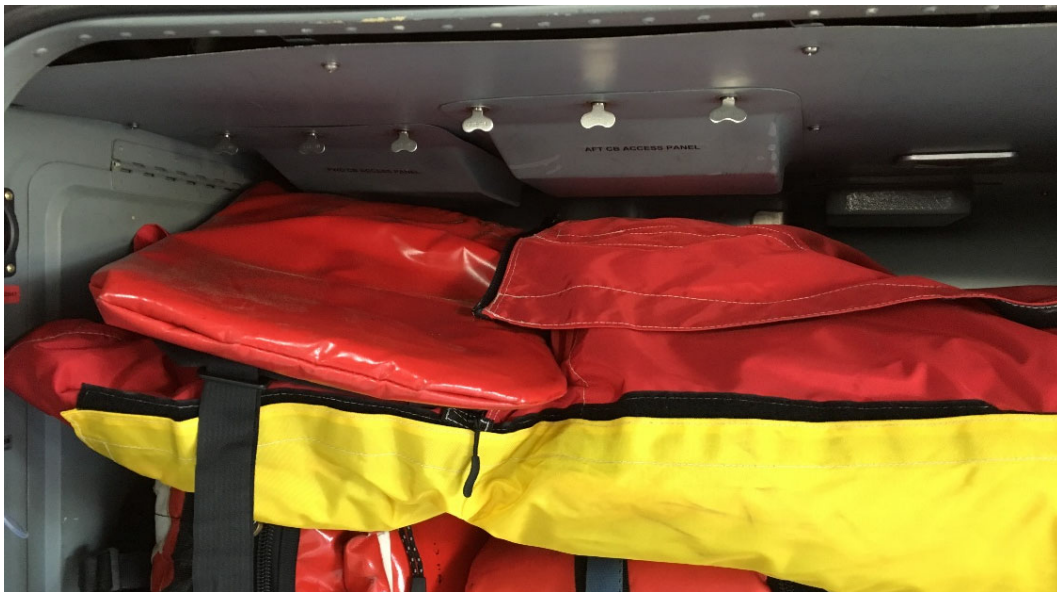
Abbildung 1: Gepäckraum einer AW109SP der REGA, in dem ähnlich wie beim vorliegenden Zwischenfall eine Vakuummatratze mit Bergungssack auf anderen Ausrüstungsgegenständen deponiert wurde.
