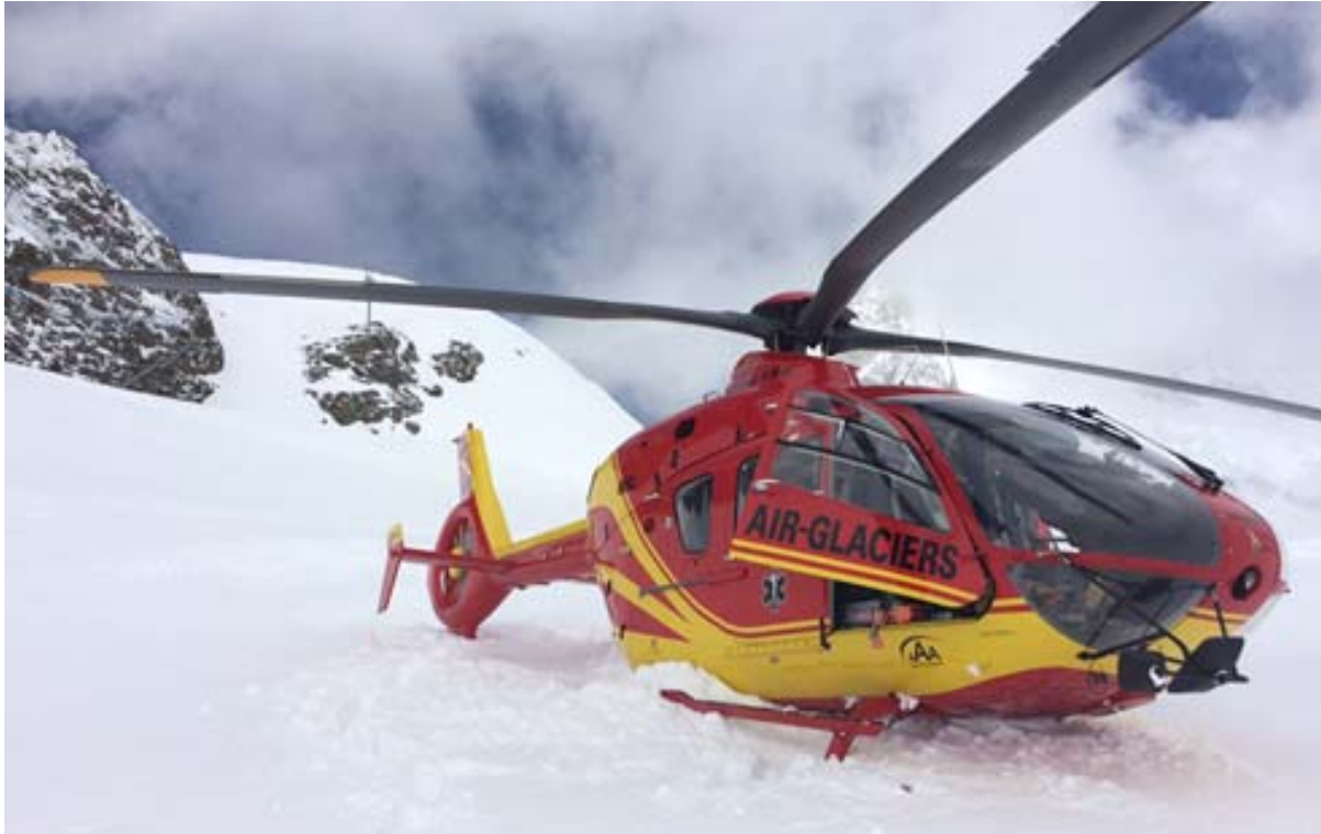
Abbildung 2: Endposition der HB-ZRK nach Gleitlandung ( running landing ) im Pulverschnee südöstlich der Sphinx (Blickrichtung Norden).
