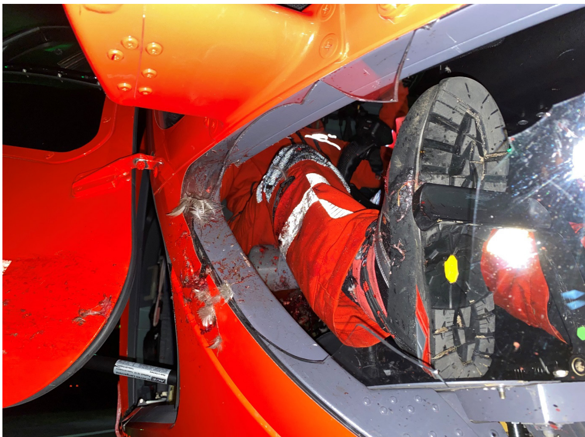
Figure 2 : Illustration de la zone endommagée par la collision avec le pilote en place.
