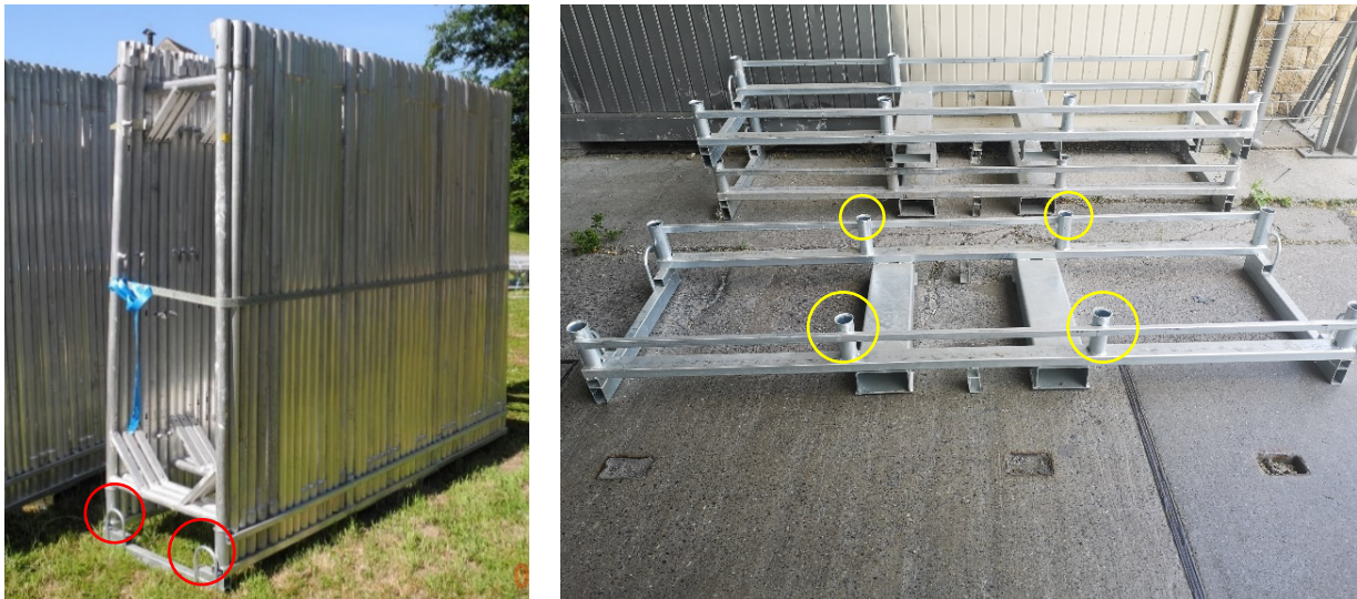
Abbildungen 3: Barelle mit vier Stahlösen als Anschlagpunkten (rote Kreise) und den 45 Gerüstelementen, die mit einem Spanngurt horizontal gesichert waren (links). Leere Barellen mit zusätzlichen Leerhülsen (gelbe Kreise) vor dem Beladen der Gerüstelemente (rechts).
