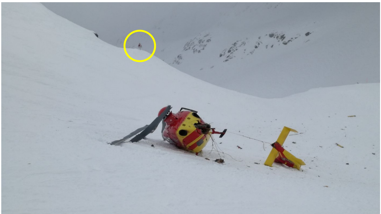
Figure 3 : Photo de l'épave prise à 10 h 09 dans le sens du départ. À l'arrière-plan on distingue un panneau de signalisation (cercle jaune) qui a servi au pilote de point de référence pour le départ.
