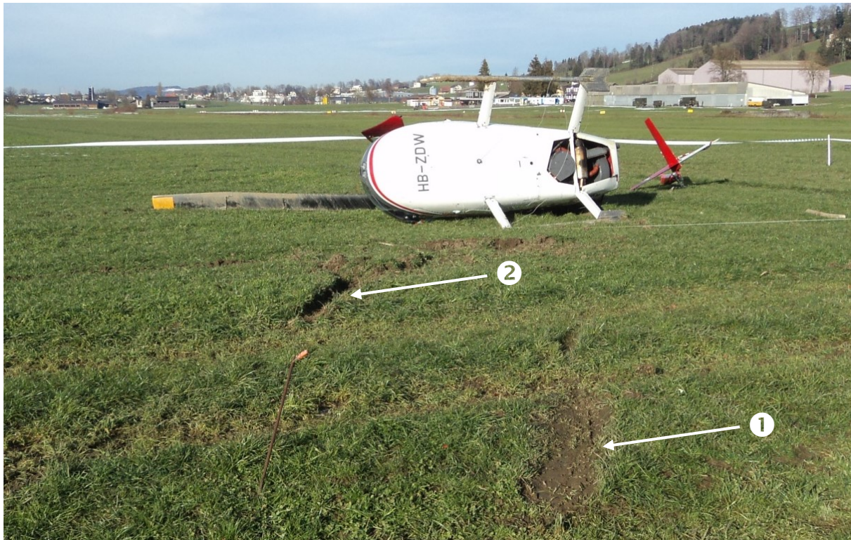
Abbildung 2: Endlage des Helikopters HB-ZDW rund 300 m südlich des Flugplatzes Luzern Beromünster (LSZO) mit den Spuren der rechten Kufe (❶) und der linken Kufe (❷) des Landegestells im weichen Wiesland, in nördlicher Blickrichtung.
