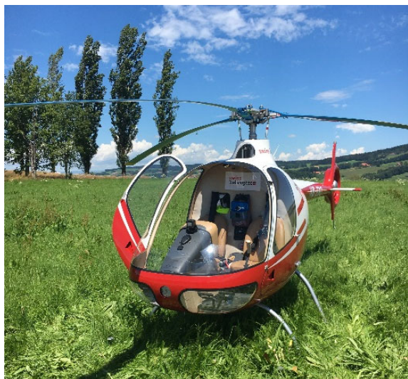
Figure 1: Gauche, Hélicoptère HB-ZDQ avec la quasi-totalité de la verrière arrachée. Droite, blessures provoquées par les impacts de morceaux de plexiglass projetés.
