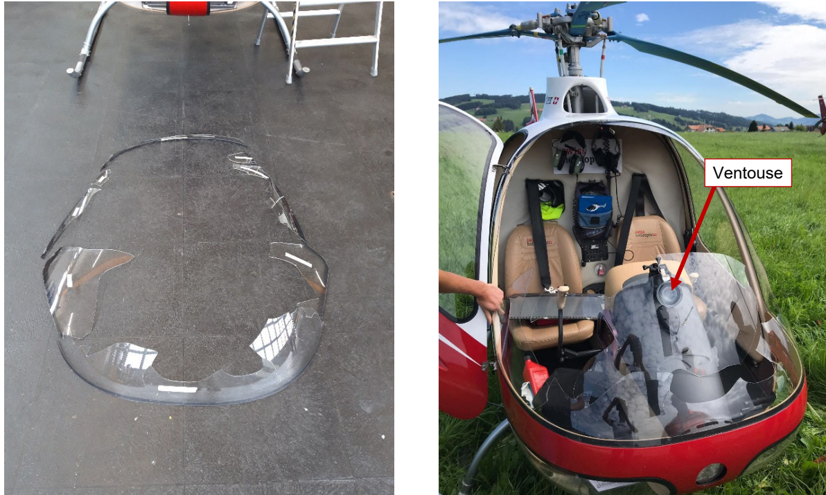
Figure 2: Gauche , verrière du HB-ZDQ complètement démontée. Les morceaux de plexiglas du milieu de la verrière se sont retrouvés en partie à l'intérieur du cockpit, d'autres ont été projetés hors de l'hélicoptère. Droite , positionnement approximatif de la ventouse de fixation pour le maintien d'une caméra embarquée.
