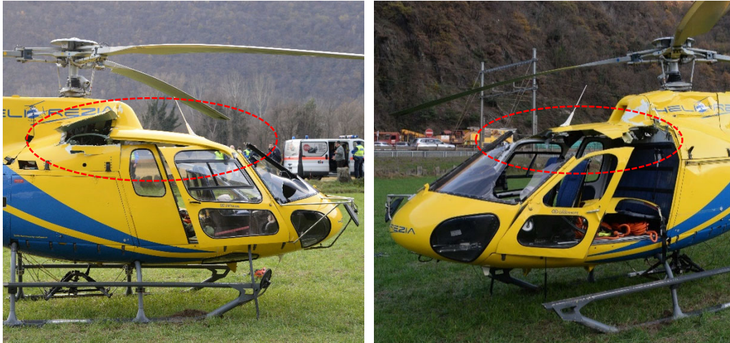
Abbildung 4 und Abbildung 5: Endlage der HB-ZCM mit Ansicht der Kabine von beiden Seiten. Das durch die Kollision mit dem Erdseil in Teilen abgetrennte Kabinendach (rot gestrichelte Kreise) ist gut erkennbar.
