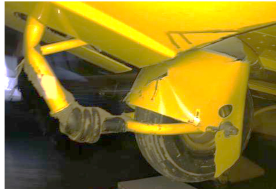
Abbildung 3: Vorderer Rumpfboden mit eingeknicktem Bugfahrwerk
