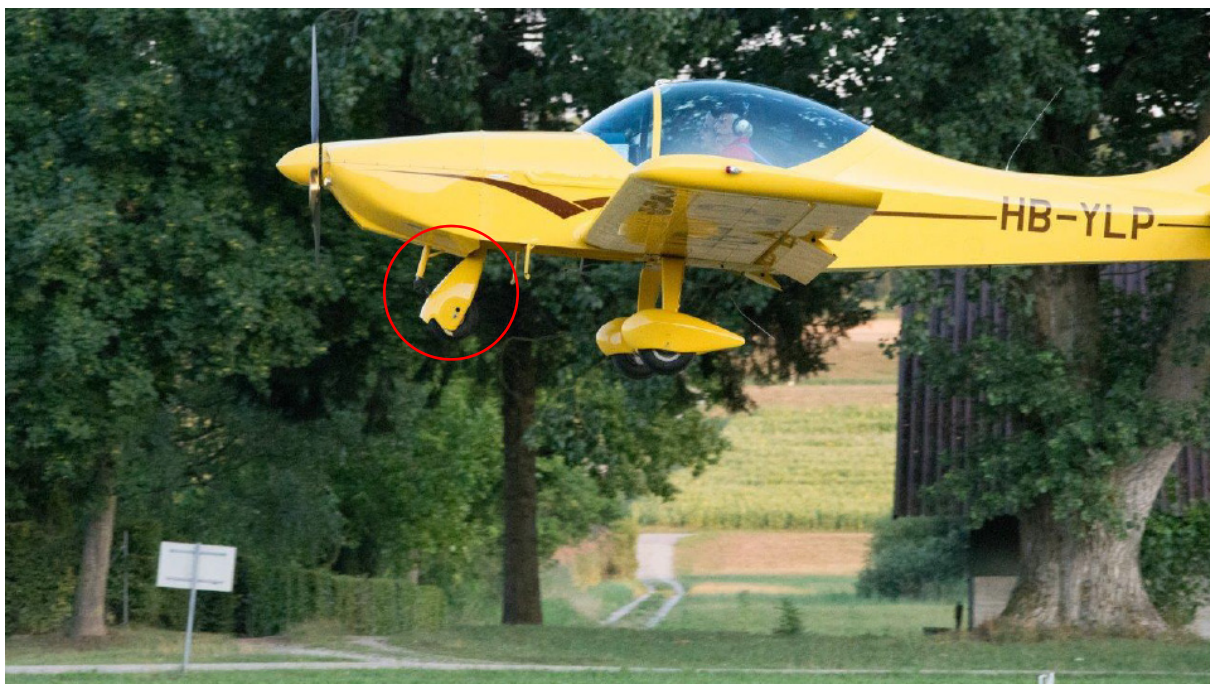
Abbildung 1: Tiefer Überflug der HB-YLP nach der harten Landung und dem Durchstartmanöver; das abgeknickte Bugfahrwerk mit nach oben angewinkelter Radverschalung ist deutlich sichtbar (roter Kreis).
