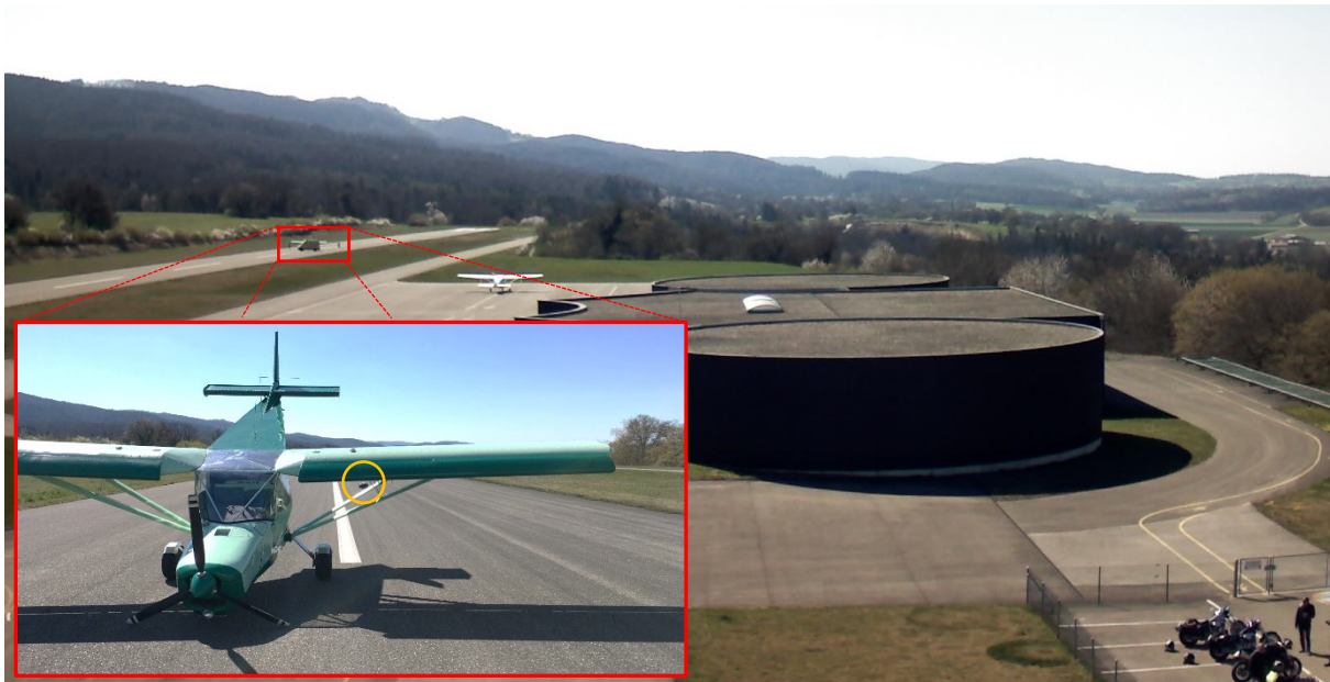
Figure 2: Webcam prise en direction de l'ouest de HB-YKC après l'atterrissage sur la piste 07 de Bressaucourt (LSZQ). La roulette avant s'est séparée du train d'atterrissage et est restée sur la piste (cercle orange sur la photo en insert).
