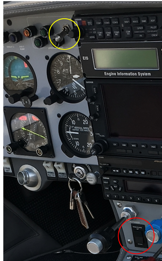
Figures 2: Le tableau de bord du HB-YFR (côté gauche) avec l'interrupteur à bascule actionner les volets (cercle rouge) et à pour le train d'atterrissage (cercle jaune). Le tableau de bord du HB-YBK (côté droit) avec l'interrupteur à bascule pour actionner le train d'atterrissage (cercle jaune) et l'interrupteur rocker pour les volets (cercle rouge) dessous de la manette des gaz.
