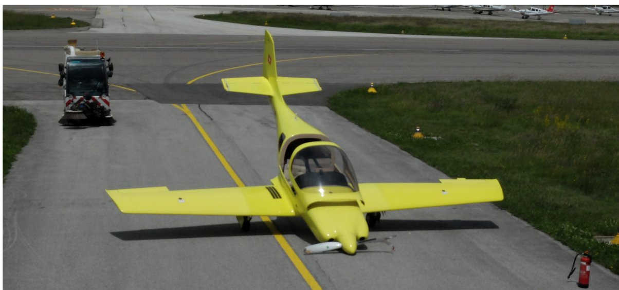
Figure 1: L'avion HB-YFR dans la position finale après que le train d'atterrissage avant a été rentré sur la voie de circulation Foxtrott .
