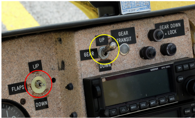
Figures 2: Le tableau de bord du HB-YFR (côté gauche) avec l'interrupteur à bascule actionner les volets (cercle rouge) et à pour le train d'atterrissage (cercle jaune). Le tableau de bord du HB-YBK (côté droit) avec l'interrupteur à bascule pour actionner le train d'atterrissage (cercle jaune) et l'interrupteur rocker pour les volets (cercle rouge) dessous de la manette des gaz.
