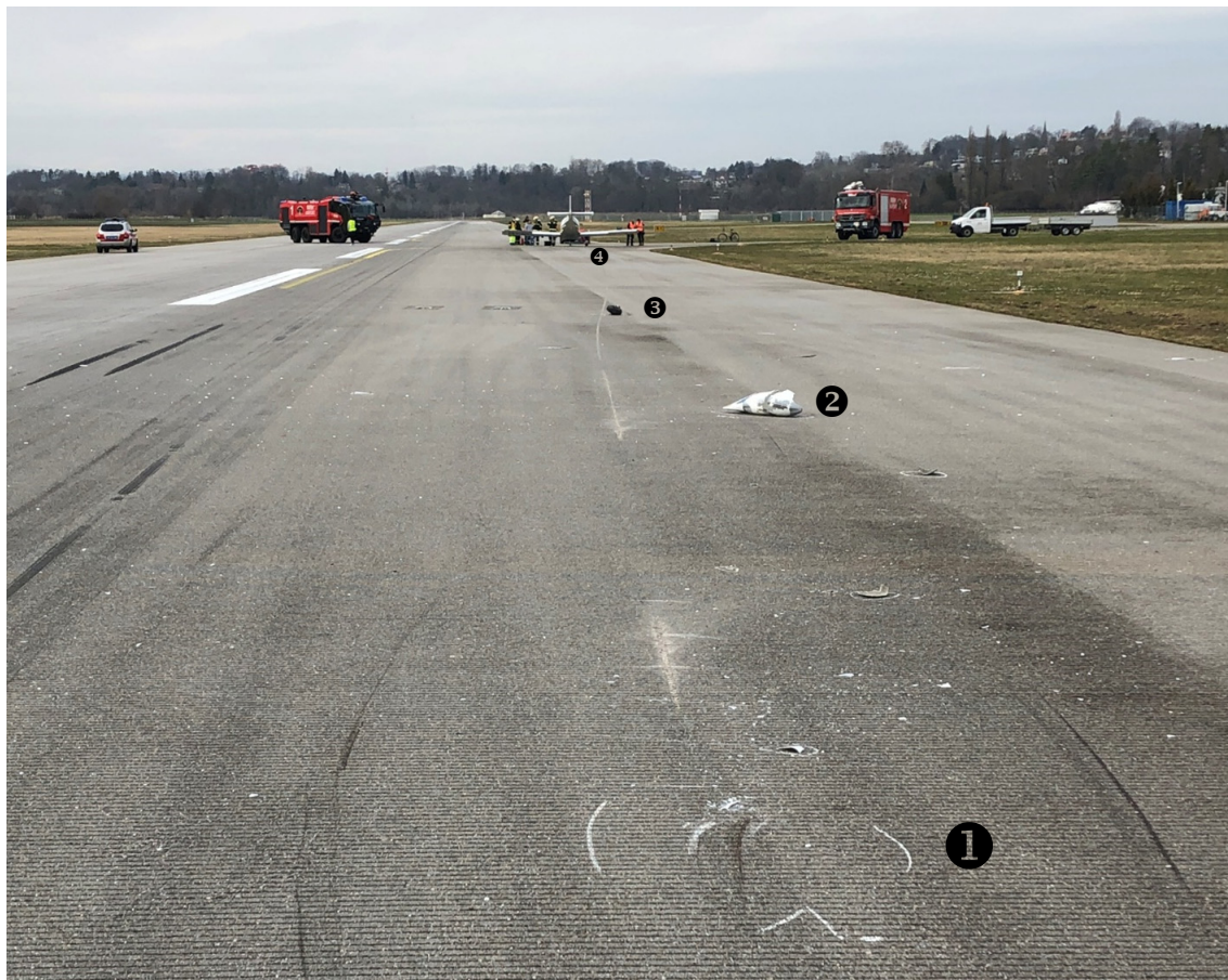
Abbildung 1: Aufschlagspuren auf der Piste 32 vom fünften und letzten Aufprall der HB-WZB, bei dem das Bugfahrwerk einbrach (1). Die Bugradverschalung (2), das abgebrochene Bugrad (3) und die Endlage der HB-WZB (4) sind im Hintergrund sichtbar.
