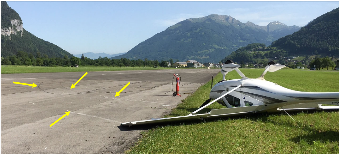
Abbildung 1: Aufnahme der HB-WYD in ihrer Endlage neben der Piste des Flugplatzes Mollis mit Blickrichtung nach Norden. Die gelben Pfeile zeigen die durch den Unfallhergang entstandenen Spuren.
