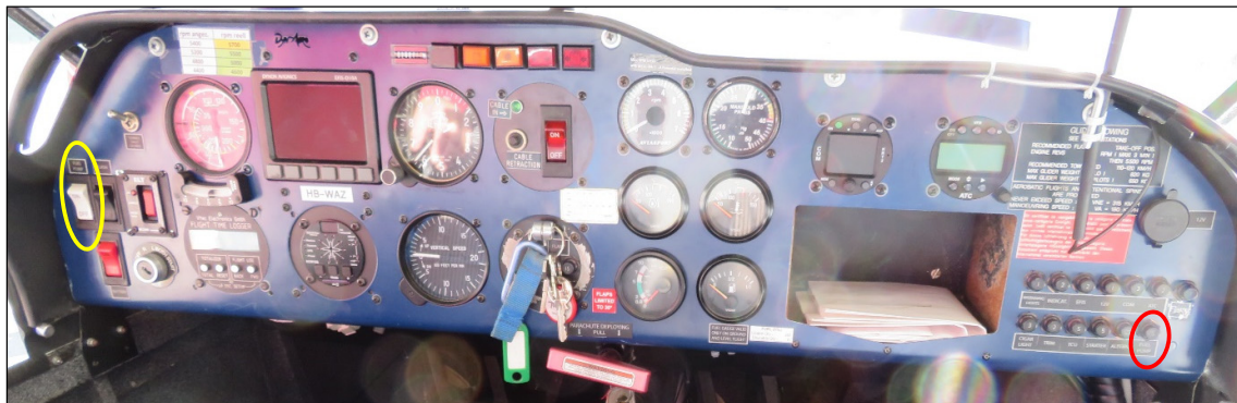
Abbildung 2: Instrumentenpanel der HB-WAZ mit dem Sicherungsautomaten der elektrischen Haupt-Kraftstoffpumpe auf der rechten Seite des Panels (rot eingekreist) und dem Kippschalter der elektrischen Hilfs-Kraftstoffpumpe auf der Pilotenseite (gelb eingekreist).
