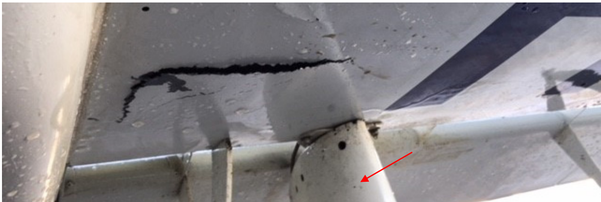
Abbildung 1: Riss auf der linken Flügelunterseite im Bereich der Flügelwurzel mit linker Hauptfahrwerksstrebe (roter Pfeil), entgegen der Flugrichtung gesehen.
