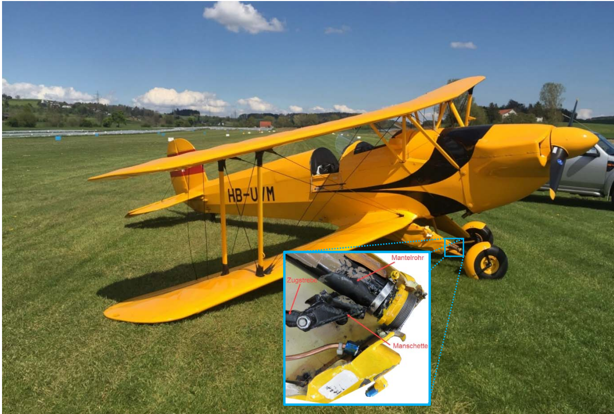
Abbildung 1: Das Flugzeug HB-UVM mit eingeknicktem Fahrwerk aufgrund eines Manschettenbruches (blau markiert) nach der Landung
