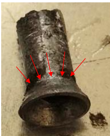
Abbildung 1: linkes Fahrwerkbein (links) mit dem vergrößerten Ausschnitt (rechts) des Übergangsstücks ①, zwischen dem starren und dem flexiblen Abschnitt der hydraulischen Bremsleitung; das Übergangsstück ①, bestehend aus einem Gewinde ② und zwei Überwurfstücken ③, enthält eine konische Fassung ( fitting ) ④ sowie eine konisch geformte Endleitung ⑤ als Gegenstück. Die blauen Spuren am Fahrwerkbein sind auf einen Austritt von Flugbenzin zu einem früheren Zeitpunkt zurückzuführen.
