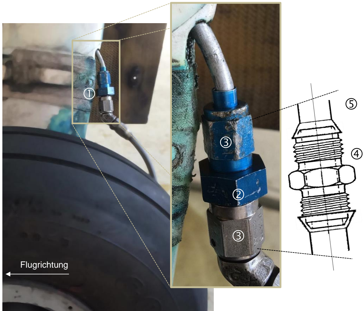
Abbildung 1: linkes Fahrwerkbein (links) mit dem vergrößerten Ausschnitt (rechts) des Übergangsstücks ①, zwischen dem starren und dem flexiblen Abschnitt der hydraulischen Bremsleitung; das Übergangsstück ①, bestehend aus einem Gewinde ② und zwei Überwurfstücken ③, enthält eine konische Fassung ( fitting ) ④ sowie eine konisch geformte Endleitung ⑤ als Gegenstück. Die blauen Spuren am Fahrwerkbein sind auf einen Austritt von Flugbenzin zu einem früheren Zeitpunkt zurückzuführen.
