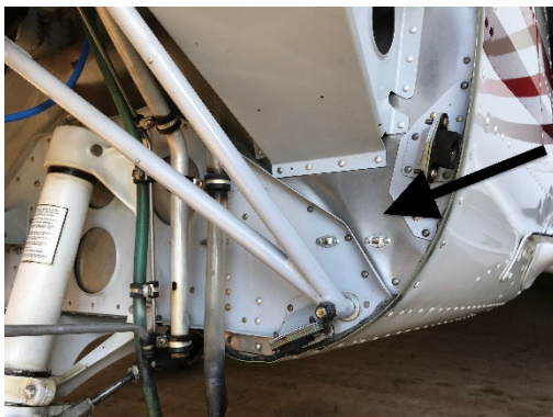
Figure 3 : déformations de la cloison pare-feu.
