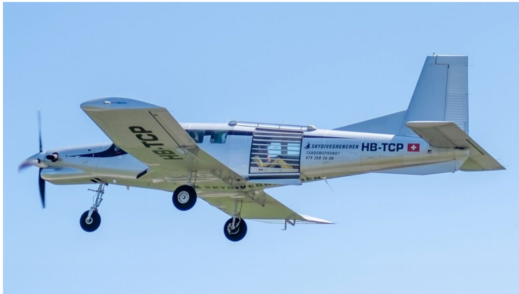
Abbildung 1: Aufnahme der HB-TCP, die das zwischen Flügel und Leitwerk befindliche Tor zum Absetzen von Fallschirmspringern in geschlossenem Zustand zeigt. Über dem Tor ist ein Handlauf zu erkennen, darunter ein Trittbrett (Foto: Skydive Grenchen).
