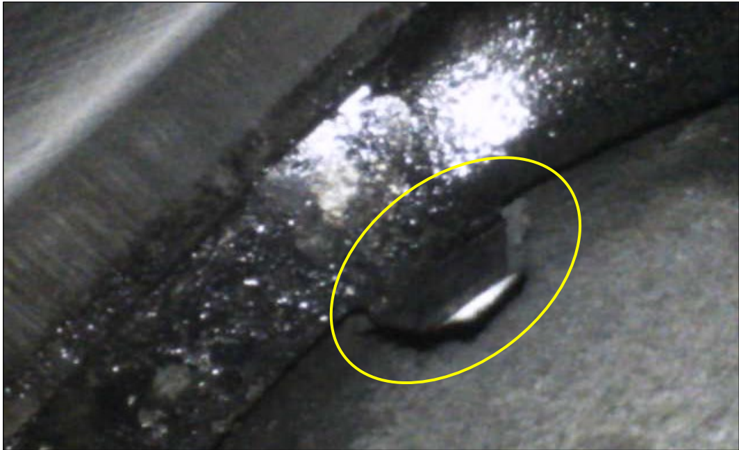
Abbildung 1: Borescope -Aufnahme mit dem defekten Auslassventil des Zylinders #2 (ausbruchartiger Bereich gelb eingekreist).
