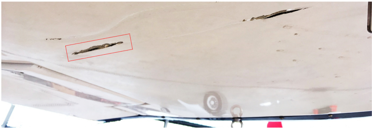
Abbildung 1: Linke Flügelunterseite zum Flügelende hin gesehen mit Beulen und Rissen. Der in der nachfolgenden Abbildung hervorgehobene Riss ist rot umrandet.
