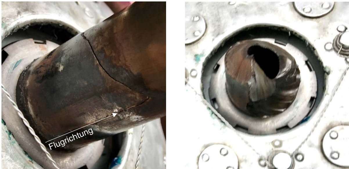
Abbildungen 1: Tiefer, korrodierter Riss an der Kurbelwelle unterhalb des Propellerkonus (links) sowie die Bruchstelle nach der weiteren Demontage (rechts).
