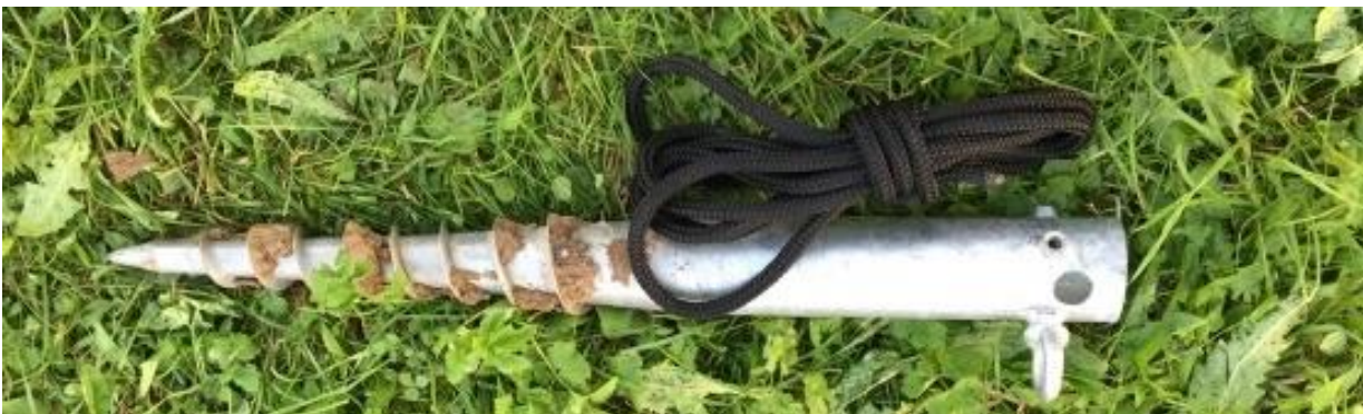
Abbildung 2: Verwendeter Bodenanker der HB-QNX
