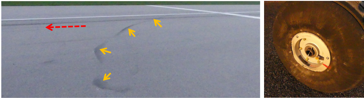
Figura 1: A sinistra, tracce del cerchione e dello pneumatico sulla pista (freccie gialle). La freccia rossa tratteggiata indica la direzione della pista 26R. A destra, pneumatico destro staccato dal cerchione.
