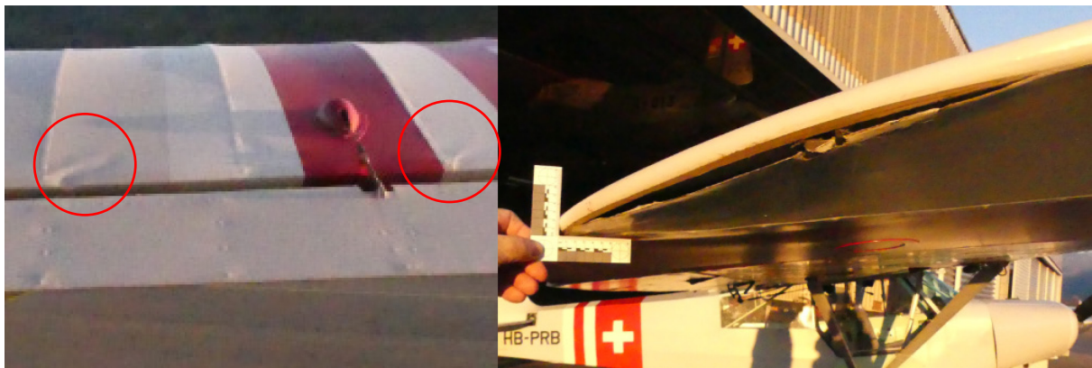
Figure 2: Déformations de la structure de l'aile droite visibles sur l'extrados (cercles rouges) et l'extrémité de l'aile droite
