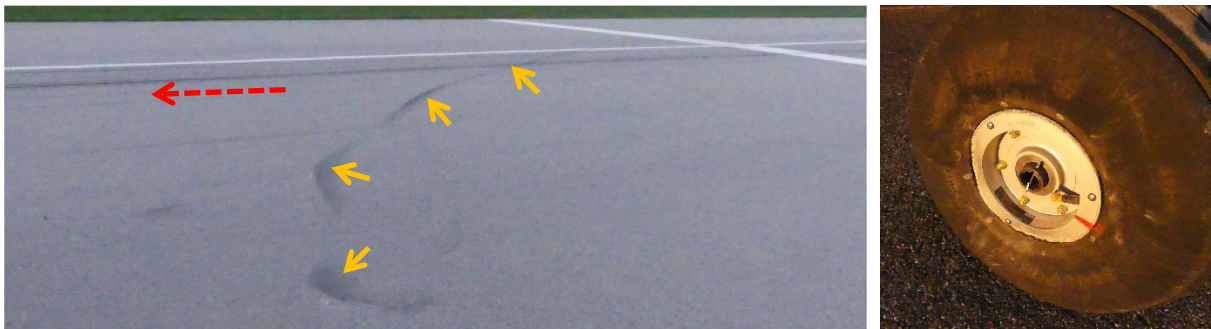
Figure 1: Gauche , Traces de la jante et du pneumatique sur la piste (Flèches jaunes). La flèche rouge discontinue indique la direction de piste 26R. Droite , pneumatique droit déjanté.
