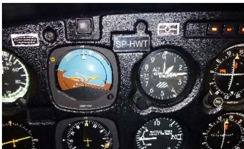
Figure 4: la plaquette d'identification radio call n'est pas conforme à l'avion HB-PJP.
