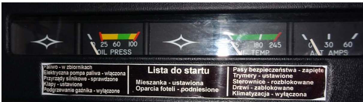
Figure 6: check-list de décollage placée sous les indicateurs de paramètre du moteur, établie en langue étrangère, non conforme au POH.
