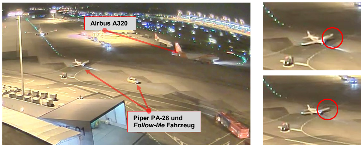
Abbildung 2: Ausschnitt aus dem Überwachungsvideo mit Darstellung. Auf den Bildern rechts ist zu erkennen, wie der Flügel der HB-PHD angehoben wird.
