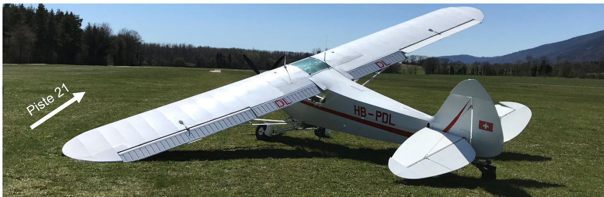
Figure 1: position finale sur la piste 21 en herbe à Montricher du remorqueur HB-PDL en appui sur son aile gauche.
