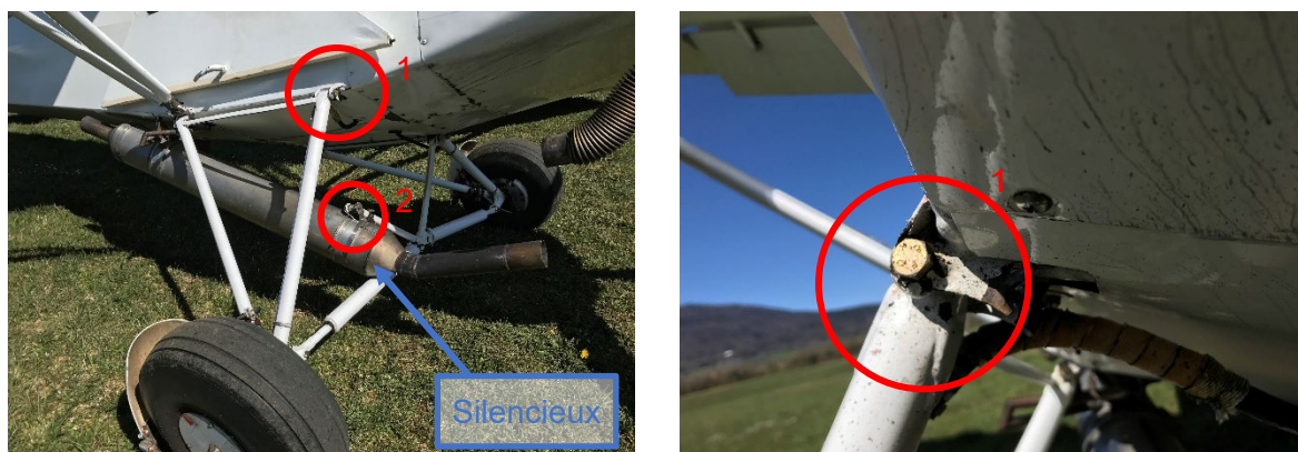
Figure 2: Rupture du point d'attache avant droit (1) de la structure tubulaire en triangle du train d'atterrissage principal. L'extrémité (2) du tube latéral s'est désolidarisé de son point d'attache (1).
