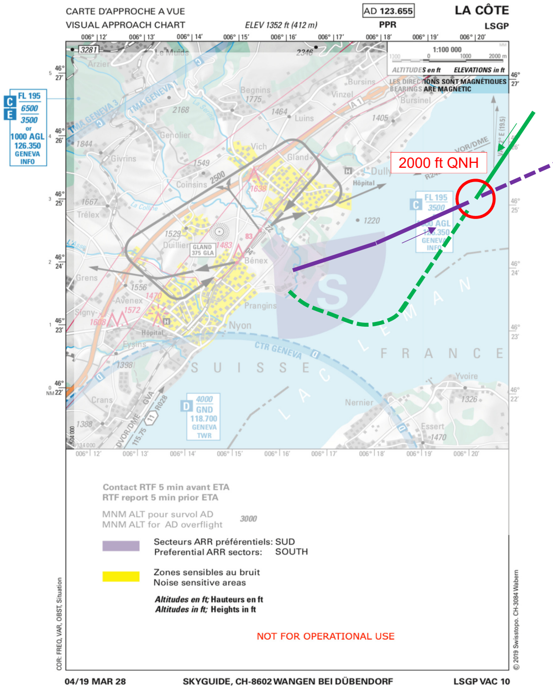
Figure 1: Carte d'approche à vue de l'aérodrome de La Côte annotée par le SESE ; les trajectoires qualitatives des deux aéronefs figurent en vert pour l'hélicoptère et en violet pour l'avion. L'endroit du rapprochement dangereux est illustré avec le cercle rouge. Les lignes discontinues représentent les trajectoires envisagées par les pilotes après l'incident.
