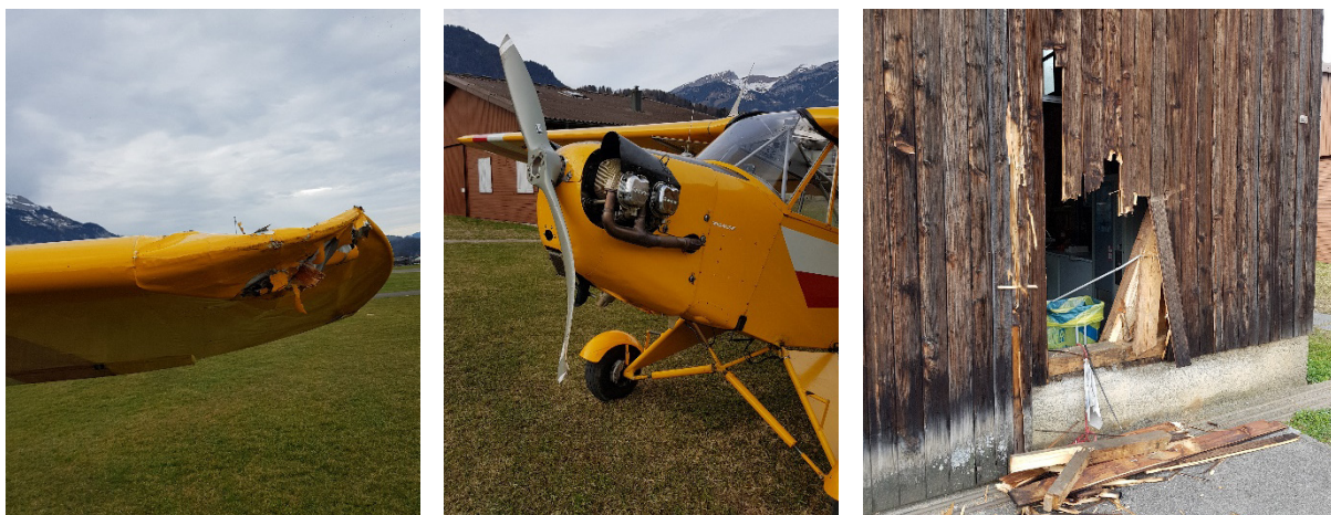
Abbildungen 1: Beschädigtes Flugzeug HB-ONA und Schaden an der Hangarwand
