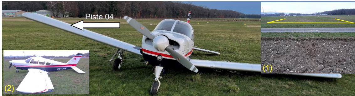
Figure 2 : Position finale du HB-OHW au nord de la piste 04 avec l'axe longitudinale orienté environ au cap 320. L'impact de la roue gauche dans le champ labouré (1) et la position du HB-OHW (2) après le seuil de piste 04 (trait jaune).
