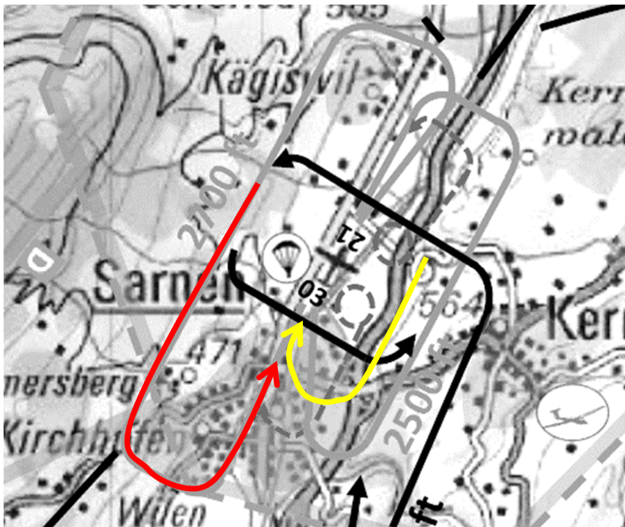
Abbildung 2: Ausschnitt aus der Sichtanflugkarte mit den beiden Platzvolten für die Piste 03/21 sowie dem eingezeichneten Flugweg der HB-ODH (rot) respektive der HB-EDB (gelb).
