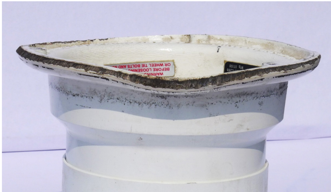
Figure 5 : Déformations clairement visibles sur la jante de la roue droite.
