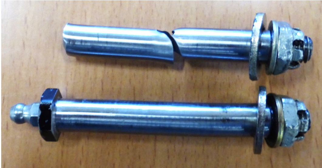
Figure 6: boulon de graissage rompu de la jambe de suspension droite ainsi que le boulon de graissage déformé de la jambe de suspension gauche.
