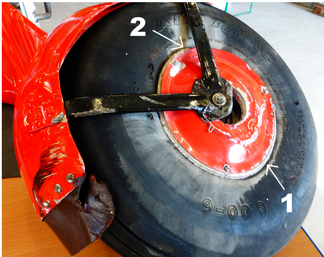
Figure 4: déformations aux positions 1 et 2 avec de fortes traces de frottement sur le bord extérieur de la jante de la roue droite.
