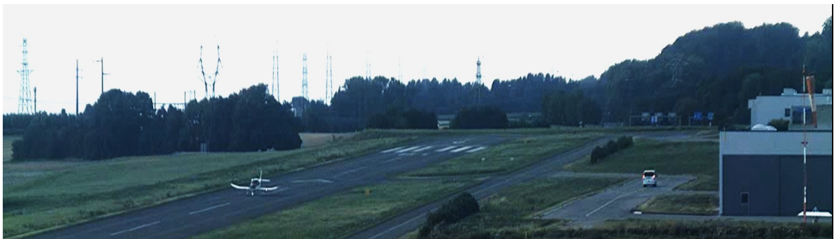
Figure 6 : HB-KLT au deuxième touché à 19:07:18 avec une vitesse sol de 140 km/h
