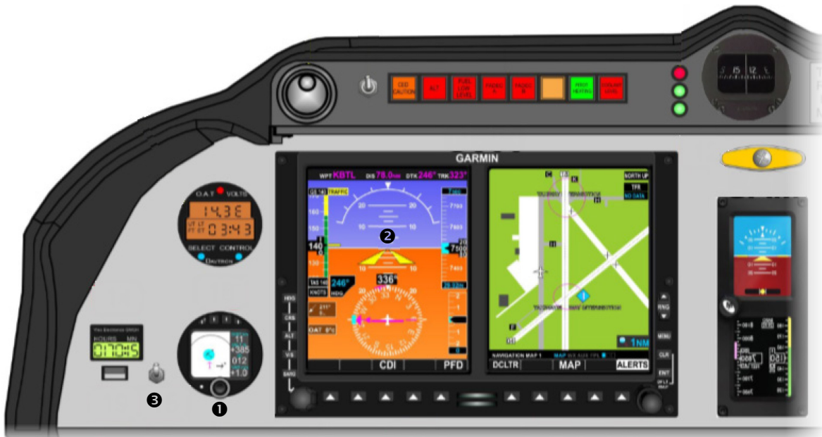
Abbildung 2: Optische Warnung vor anderem Luftverkehr werden auf dem ATD (1) links vom Primary Flight Display (2) direkt vor dem Pilotensitz ausgegeben. Über den Kippschalter (3) können die akustische Warnungen stummgeschaltet werden kann.
