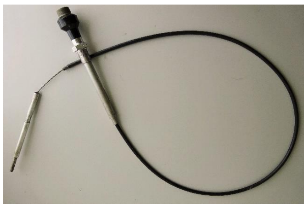
Fig. 4: Vue de la commande des gaz complète.
