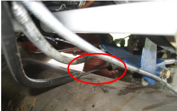
Fig. 1: Vue sur le moteur de l'avion, gaine flexible de la commande des gaz désolidarisée de sa partie rigide.
