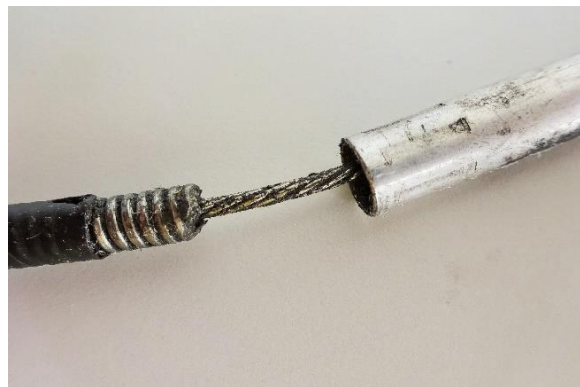
Fig. 2: Détail de la gaine flexible de la commande des gaz désolidarisée de sa partie rigide.
