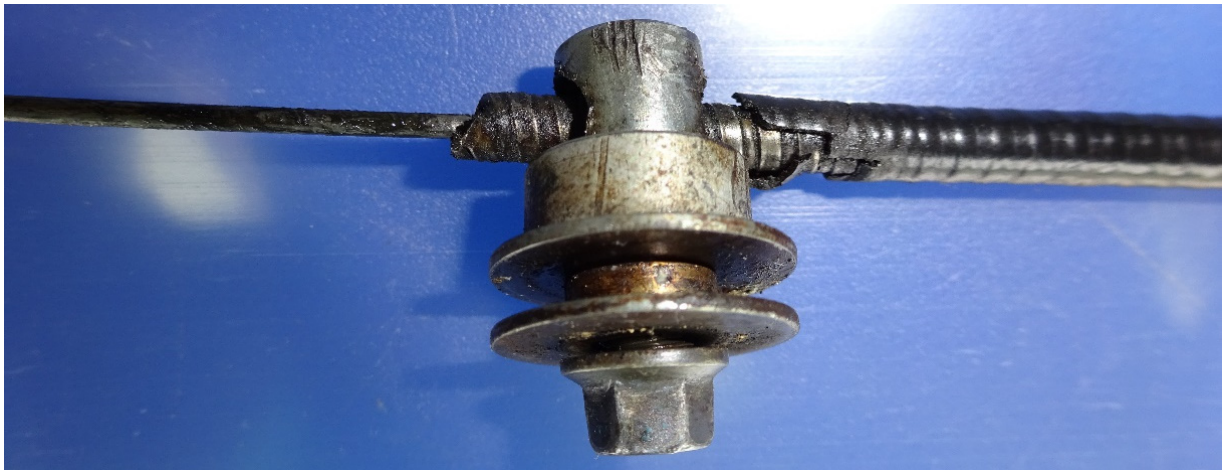
Figure 2: éléments du flexible de la commande de mixture et de l'arrêt de gaine déposés du HB-KFD
