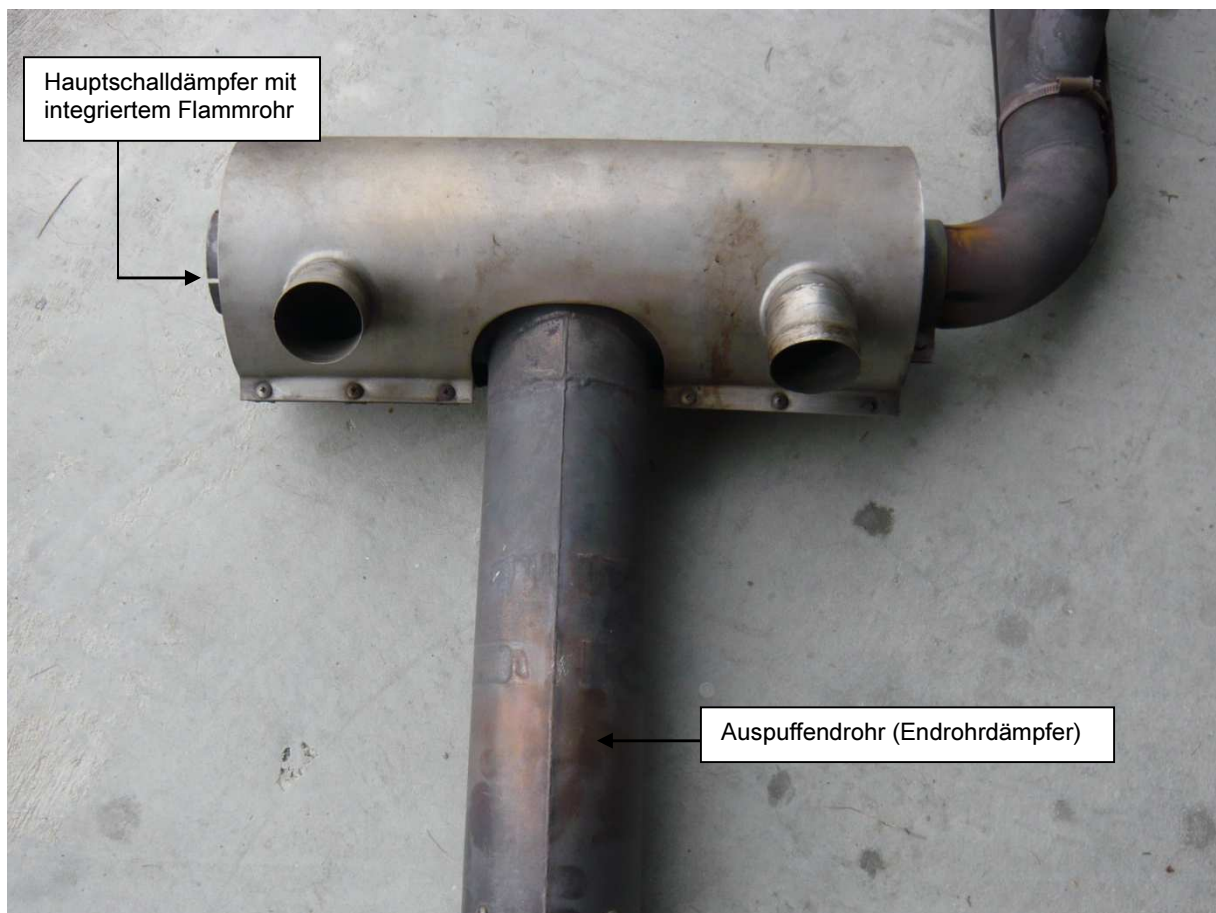
Abbildung 2: Auspuffanlage mit Hauptschalldämpfer und Auspuffendrohr (Endrohrdämpfer).
