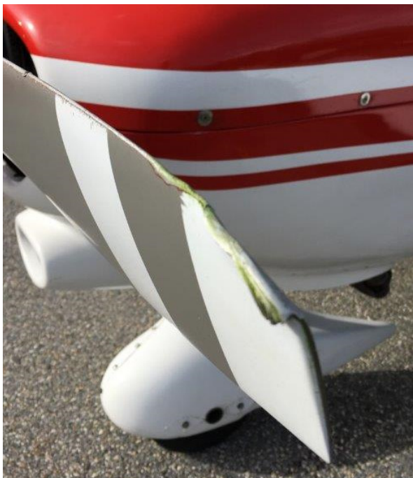
Figure 1: hélice du HB-KAW endommagée
