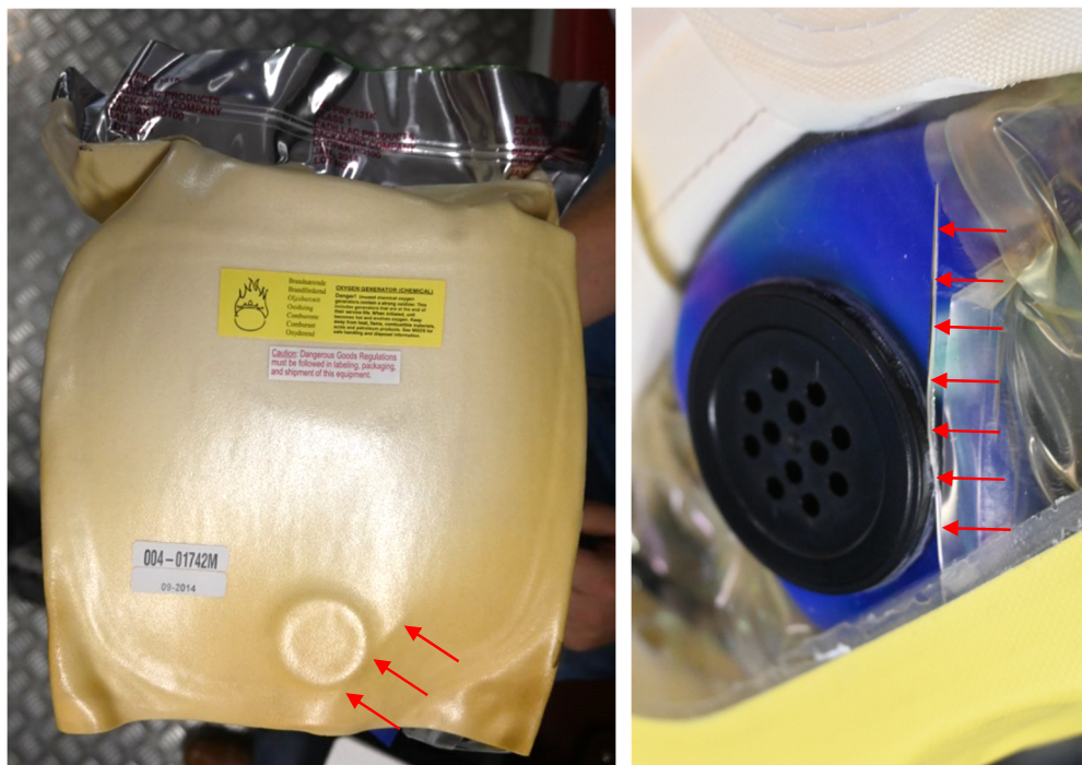
Abbildung 8: Unversehrte Vakuumverpackung mit erkennbarem Riss in der Frontscheibe der PBE (linkes Bild, rote Pfeile); gleicher Riss nahe der Mund-Nasen-Maske bei der ausgedruckten PBE (rechtes Bild, rote Pfeile).
