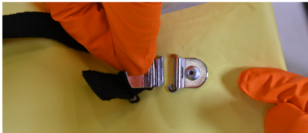
Abbildung 5: Abgerissene Halterung des rechten seitlichen Halteriemens einer PBE, die während des schweren Vorfalls eingesetzt wurde.
