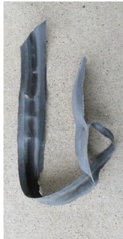
Abbildung 2: Stark beschädigte Dichtmanschette.
