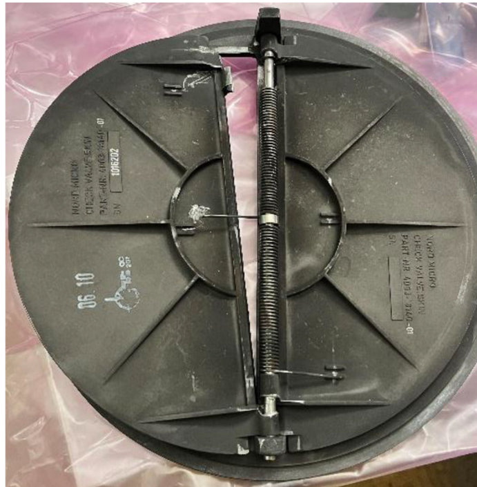
Abbildung 3: Defektes skin check valve.
