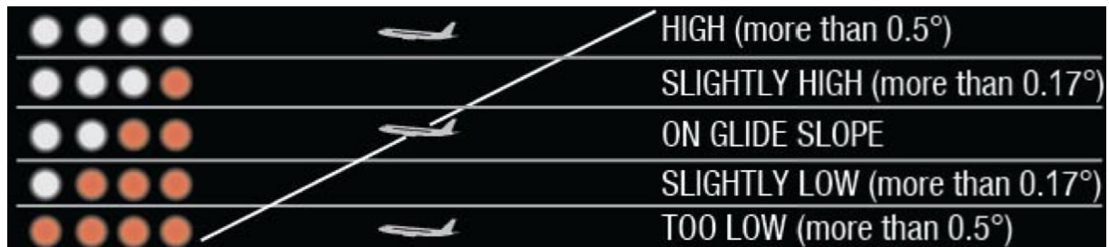
Abbildung 2: Anzeigen der Präzisionsanflug-Gleitwinkelbefuerung ( Precision Approach Path Indicator – PAPI) bei verschiedenen Abweichungen vom nominalen Gleitwinkel
