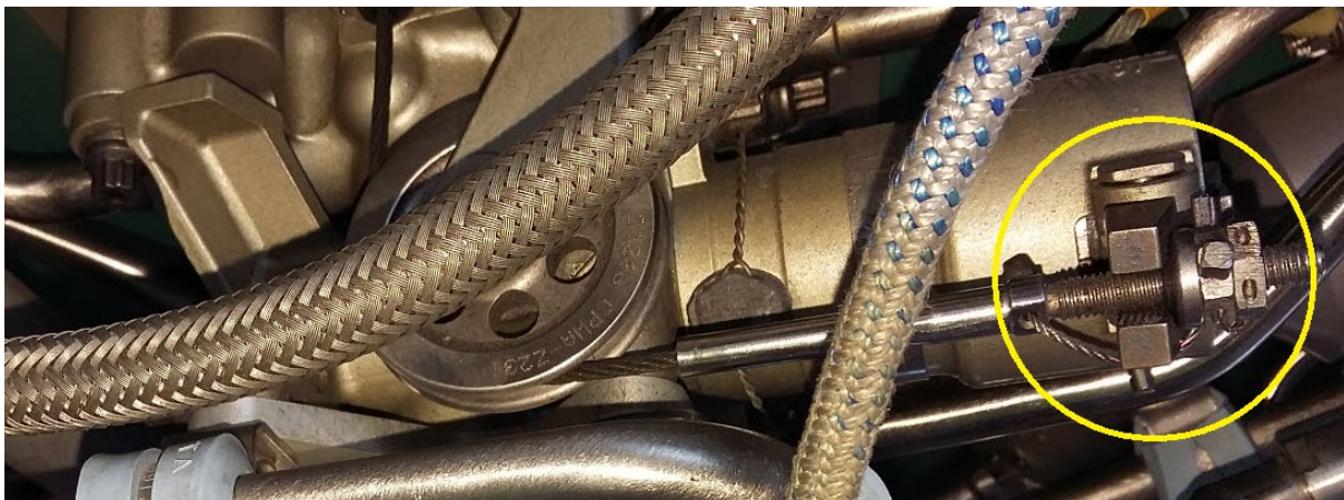
Abbildung 2: Das emergency fuel shut-off valve mit seinem Betätigungshebel und dessen justierbarer Verbindung (gelber Kreis) zu dem über eine Umlenkrolle geführten Bowdenzug.
