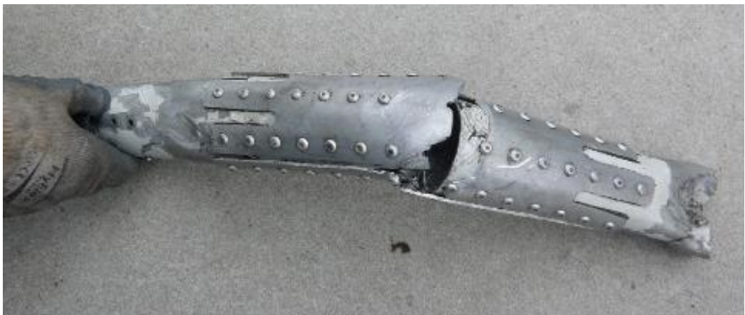
Abbildung 7: Reparatur an der Struktur eines Motorträgers. Die Halbschalen wurden direkt auf die dicke Lackschicht aufgenietet.
