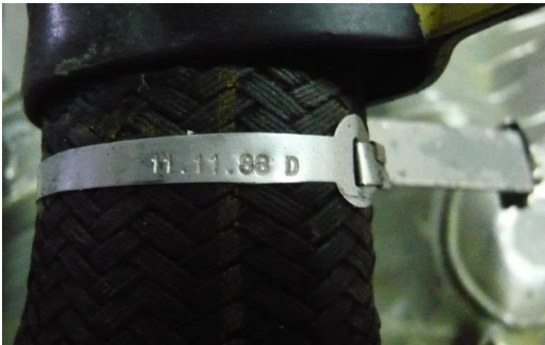
Abbildung 14: Treibstoffschlauch mit Datumsangabe (11. November 1988)
