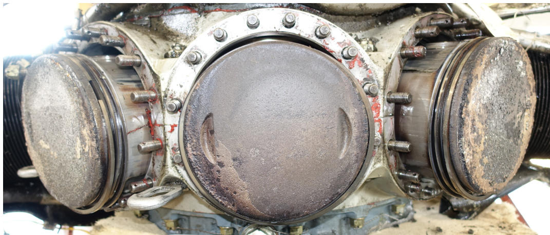
Abbildung 15: Zylinderpositionen 1, 2 und 3 des linken Motors mit Kolben.
