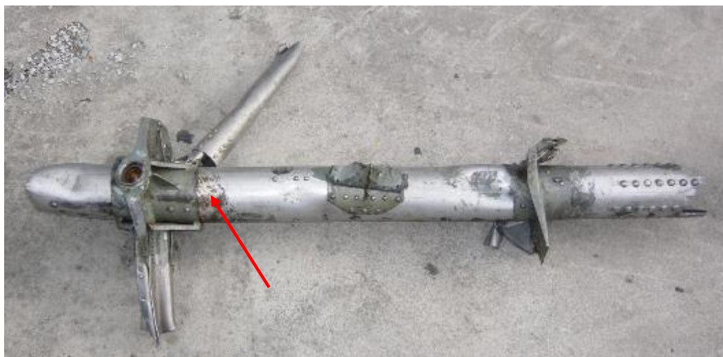
Abbildung 8: Unteres Holmrohr von Holm I des linken Flügels. Der Pfeil zeigt auf die Zone mit Rissen im Holmrohr.
