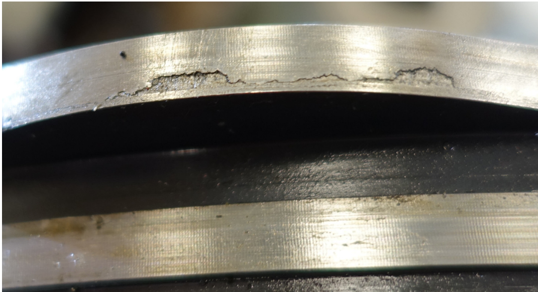
Abbildung 16: Nockenscheibe des mittleren Motors. Gut sichtbar sind die Bearbeitungsspuren (regelmässige, feingerillte Oberfläche) und die Ausbrüche auf der oberen Lauffläche.
