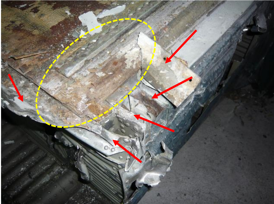
Abbildung 11: Detailansicht der Kabinenstruktur hinten rechts. Auffällig sind der morsche Holzboden (gelb markierte Zone) und die Korrosionsschäden (rote Pfeile).
