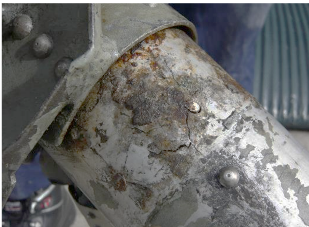
Abbildung 9: Detailansicht der Risszone am unteren Holmrohr des linken Flügels.
