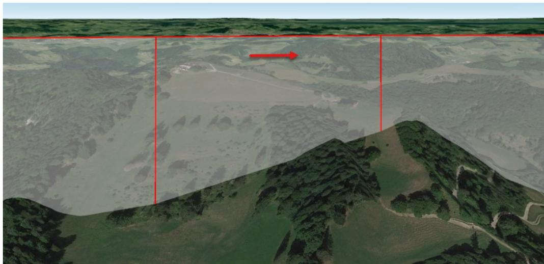
**Abbildung 55:** Horizontaler Überflug des Geländes in einer Flughöhe von 1189 m/M mit einer Überhöhung von 107 m direkt unter dem Radarflugweg sowie 165 m in Bezug auf den tiefsten Punkt des Geländeprofiles. Dargestellt in Google Earth.
