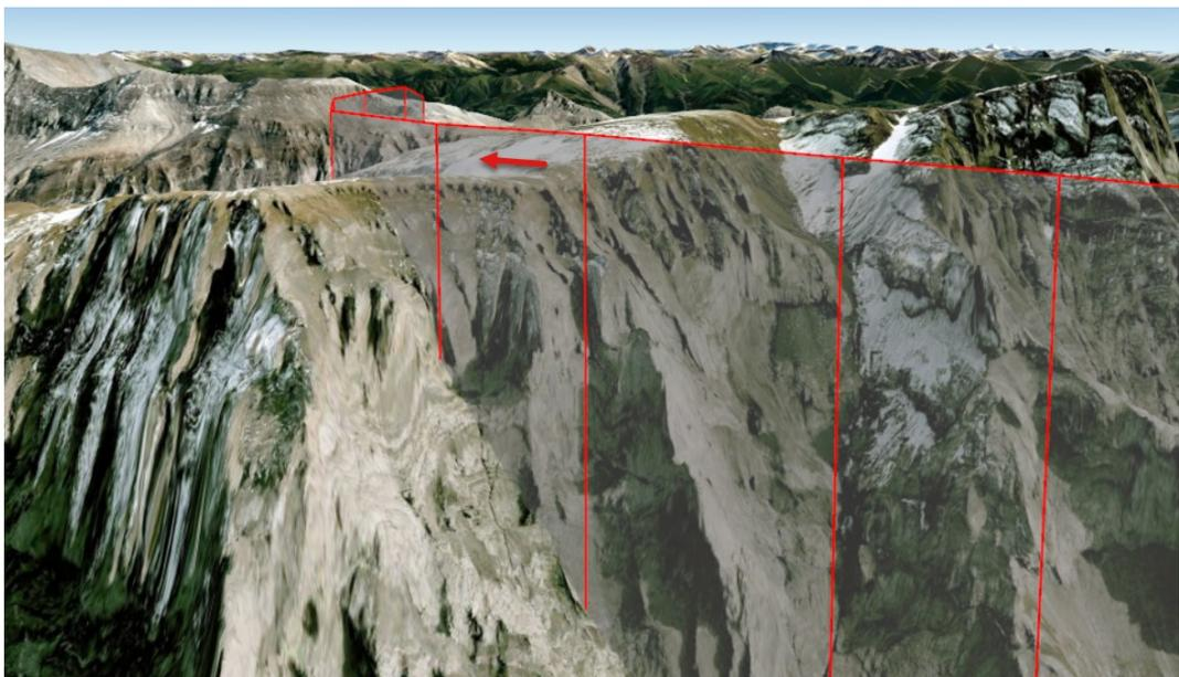
**Abbildung 17:** Horizontaler Überflug rechtwinklig zur Gebirgskrete in einer Flughöhe von 2982 m/M mit einer Überhöhung von 88 m direkt unter dem Radarflugweg sowie 96 m in Bezug auf den tiefsten Punkt des Geländeprofiles. Dargestellt in Google Earth.
