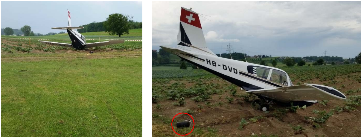
Abbildung 1: Rollspuren der HB-DVD (links) sowie deren Endlage im Ackerland mit abgetrenntem Bugfahrwerk (rot eingekreist) nach dem Pistenende 06 des Flugplatzes Lommis (LSZT)
