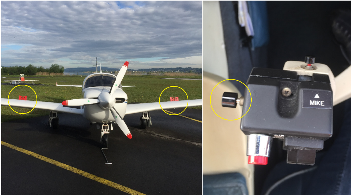
Abbildung: Speed brakes im ausgefahrenen Zustand und deren Bedienknopf am Steuerhorn.
